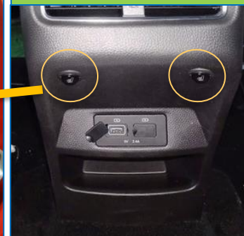
Место установки кнопки управления обогревателями задних сидений
