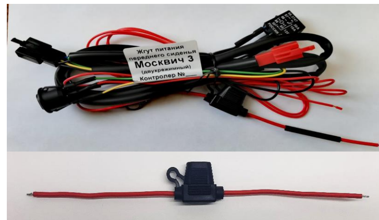
Жгут питания «2х-режимный» с кнопкой управления и с блоком предохранителя
